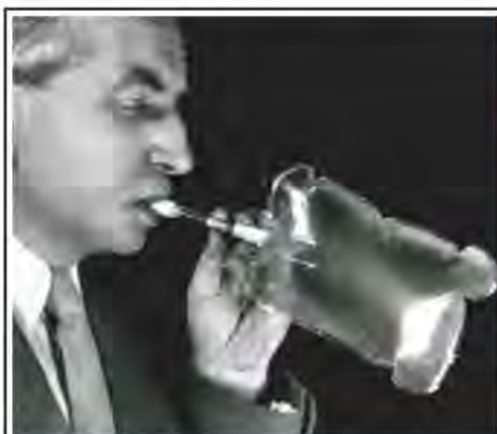
Exempel på första generationens instrument för alkoholutandningsprov för sållningsbruk: Alcotestampull och ballong.
