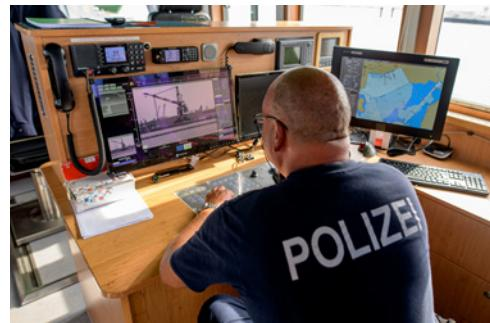
Das Multi-Sensor-System ermöglicht die optische Überwachung unter nahezu allen Wetterbedingungen bei Tag und bei Nacht. Objekt-Tracking, Sektor-Scan sowie wahlweise Großdarstellung der Kamerakanäle ermöglichen es, für jede Situation die richtige Bildquelle zu analysieren.
